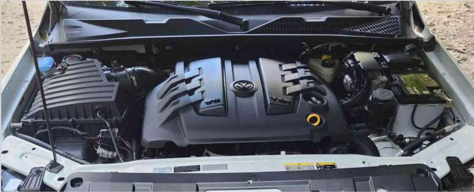
**Motor:** a diesel, dianteiro, longitudinal, 2.967 cm<sup>3</sup>, seis cilindros em “V”, quatro válvulas por cilindro, com duplo comando no cabeçote. Injeção direta de combustível do tipo common rail, acelerador eletrônico e turbocompressor de geometria variável com intercooler
