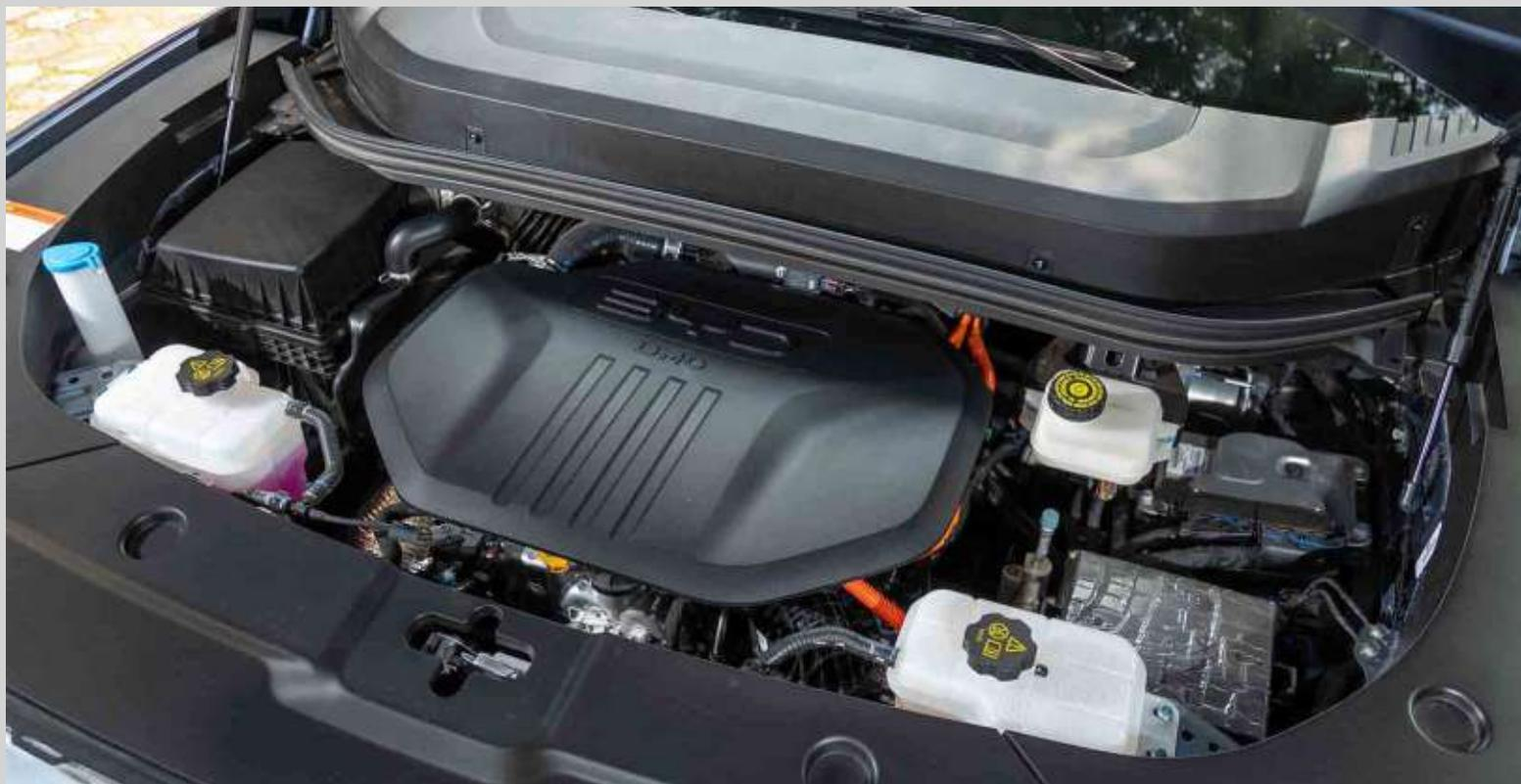
**Motor:** sistema DMO híbrido plug-in com um motor a gasolina de 1,5 litro (1.498 cm<sup>3</sup>, dianteiro, longitudinal, 4 cilindros, 16 válvulas, turbocompressor, injeção multiponto e comando único no cabeçote) combinado a dois motores elétricos, um em cada eixo
