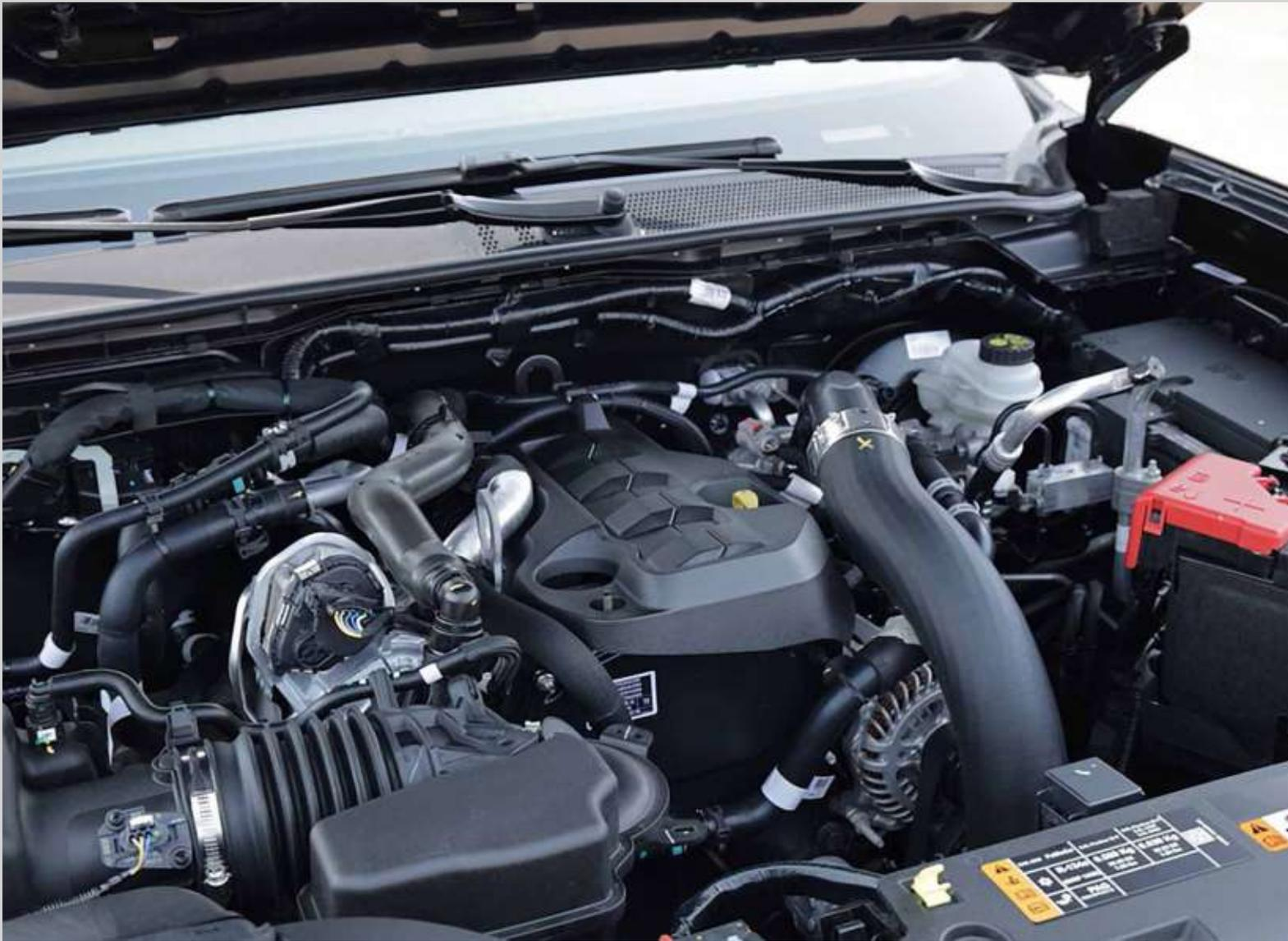
**Motorização:** 2.0 Panther turbodiesel de quatro cilindros
