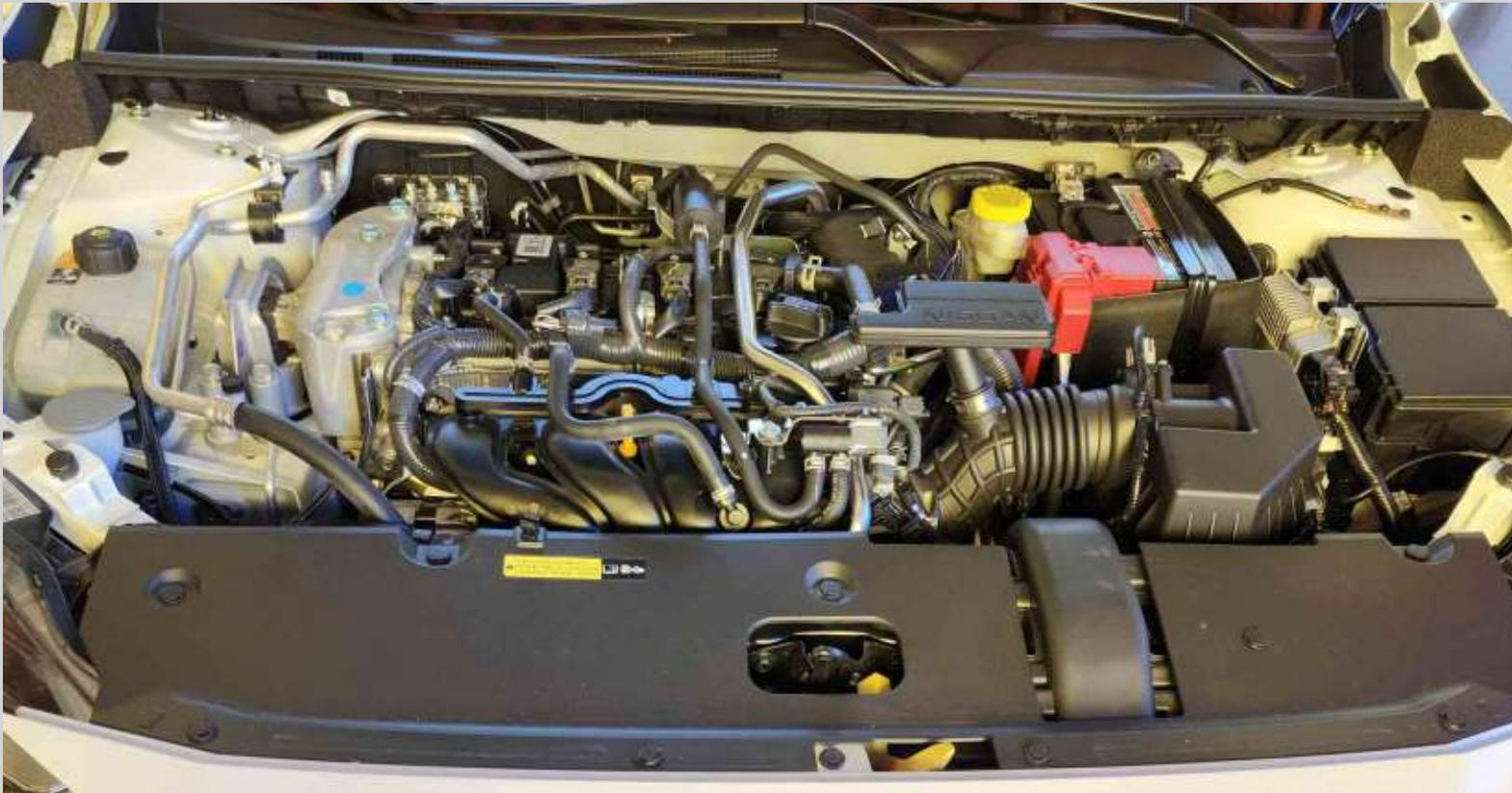
**Motor:** 2.0 a gasolina, 1.997 cm<sup>3</sup>, aspirado, quatro cilindros, 16V, controle elétrico VTC (e-VTC), injeção direta e ciclo Atkinson
