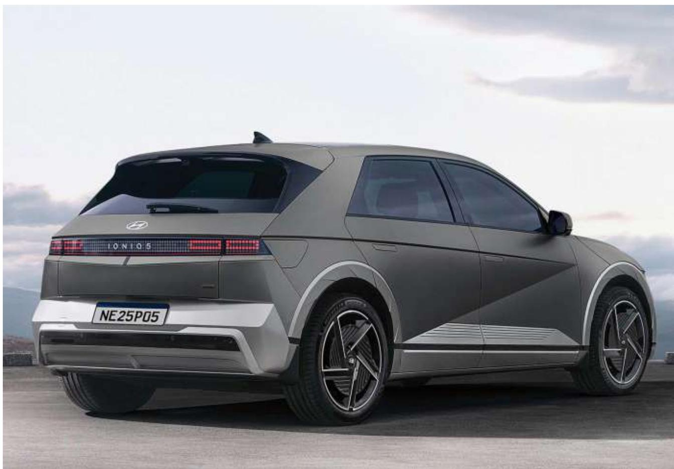
O Ioniq 5 tem uma bateria de 84 kWh, para uma autonomia de até 374 quilômetros com uma carga, segundo medição do Inmetro. O nível de carga da bateria pode ser acompanhado no painel ou em um display intuitivo junto à tomada externa de energia. Para facilitar a recarga, o carro vem com um carregador doméstico portátil em corrente alternada, com potência de 2,6 kW e plugue com padrão brasileiro, e outro de parede em corrente alternada, com potência de 7,68 kW.
