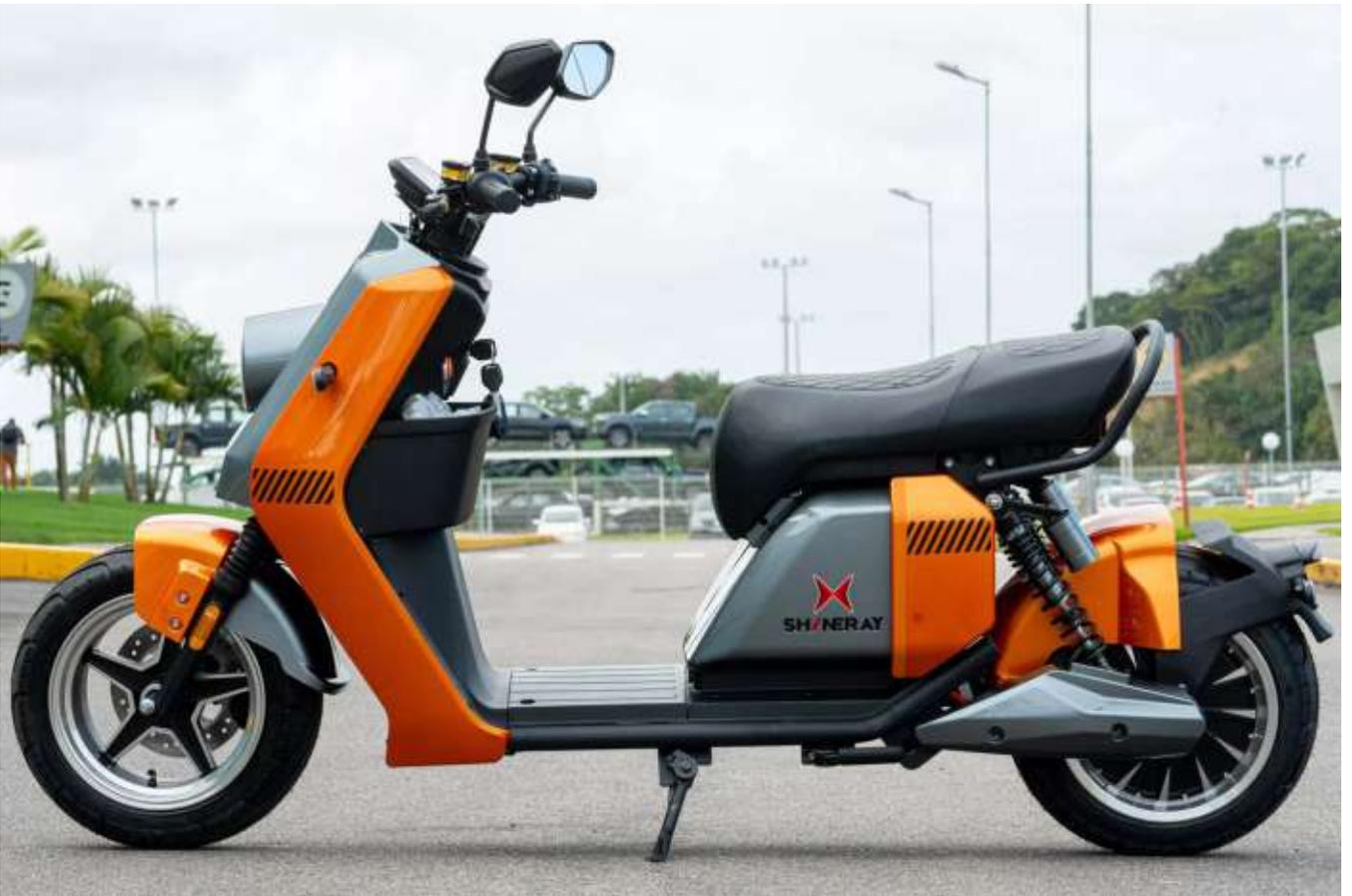
A PT4-Pro S 2025 está equipada com um motor elétrico indutivo brushless com potência nominal de 3 mil watts, capaz de atingir picos de 4.800 watts, alimentado por uma bateria de íons de lítio de 60V e 30Ah. Segundo a fabricante, o conjunto da nova scooter elétrica proporciona uma autonomia de até 40 quilômetros, com tempo de recarga variando de quatro a cinco horas.
